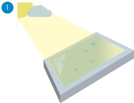
La **fotocatálisis** activada por rayos UV descompone la suciedad orgánica de la superficie del vidrio.
