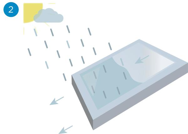
El **efecto hidrófilo** asegura que la suciedad desintegrada y el polvo adherido libremente sean transportados por el agua de lluvia (o agua en aspersión) que se escurre fácilmente por la superficie del vidrio.
